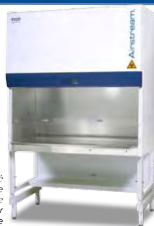
Poste de sécurité microbiologique de classe II Airstream série S avec paroi en acier inoxydable, modèle AC2-4S_.
